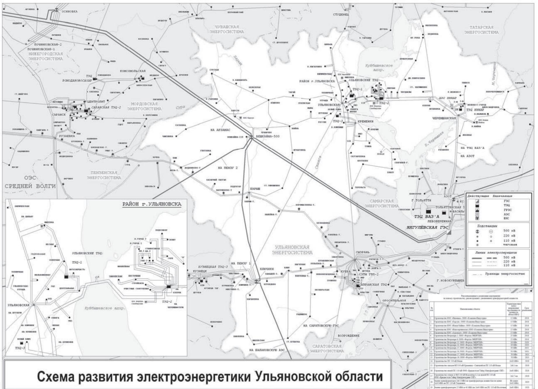
Рис. 2. Карта-схема электрических сетей классом напряжения 110 кВ и выше энергосистемы Ульяновской области на период 2019-2023 годов
